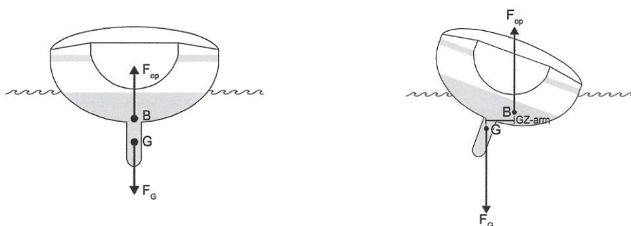
Figur 1. Opdrift og tyngdekrafts påvirkning af en båd 2
